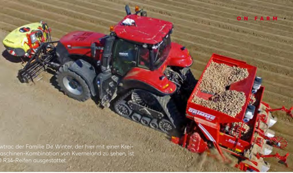
Der Case IH Rowtrac der Familie De Winter, der hier mit einer Kreiseleggen-Drillmaschinen-Kombination von Kverneland zu sehen, ist vorn mit 650/60 R34-Reifen ausgestattet.
