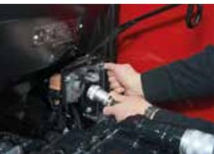
La technologie ISOBUS est le standard sur lequel les constructeurs de matériels agricoles se sont accordés pour créer un protocole de communication électronique universel entre tracteurs, équipements et ordinateurs.
