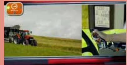
zu aktivieren; das Fahrzeug beschleunigt dann mit voller Leistung. Das CVX-Getriebe verfügt über eine Anti-Jackknife-Funktion, die ein Einknicken des Gespanns bei Transportfahrten auf abschüssigem Boden verhindert. Durch Gedrückthalten der ‚vorwärts‘-Taste der Wendeschaltung bei gleichzeitiger Betätigung des Bremspedals wird verhindert, dass das Getriebe die momentane Geschwindigkeit überschreitet.
