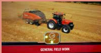
Für die allgemeine Feldarbeit ist der Feldmodus vorgesehen, der die meisten Anwendungsbereiche abdeckt. Beim Annähern an das Vorgewende wird durch entsprechende Rücknahme des Fußpedals bzw. Multicontrollers die Geschwindigkeit gedrosselt. Anschließend wird durch schnellere Bewegung des Fußpedals die Kickdown-Funktion aktiviert, um mit voller Leistung rasch wieder die Zielgeschwindigkeit zur
