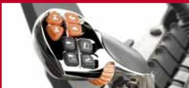
Pour tous les travaux, la poignée Multicontroller, le panneau de commande intuitif ICP et l'écran tactile permettent une conduite du bout des doigts.
