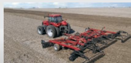
Die Case IH True-Tandem 335VT für die vertikale Bodenbearbeitung verfügen über das patentierte 'Agronomic Design' zur Saatbettbildung.
