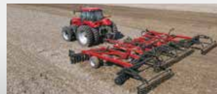
Agregaty uprawowe True-Tandem 335VT marki Case IH wyróżnia opatentowana konstrukcja rolnicza umożliwiająca tworzenie łoża siewnego.
