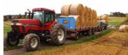
Wyposażony w szerokie opony zmniejszające nacisk na grunt ciągnik Magnum 7230 marki Case IH przy zwozieńiu bel słomy.
