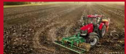
genügt ein Tastendruck, und AccuTurn Pro führt nicht nur die aufgezeichneten Funktionen aus, sondern auch den Wendevorgang und das Einfahren in die nächste Spur. Die Vorteile liegen auf der Hand: Entlastung des Fahrers und höhere Präzision am Vorgewende.
