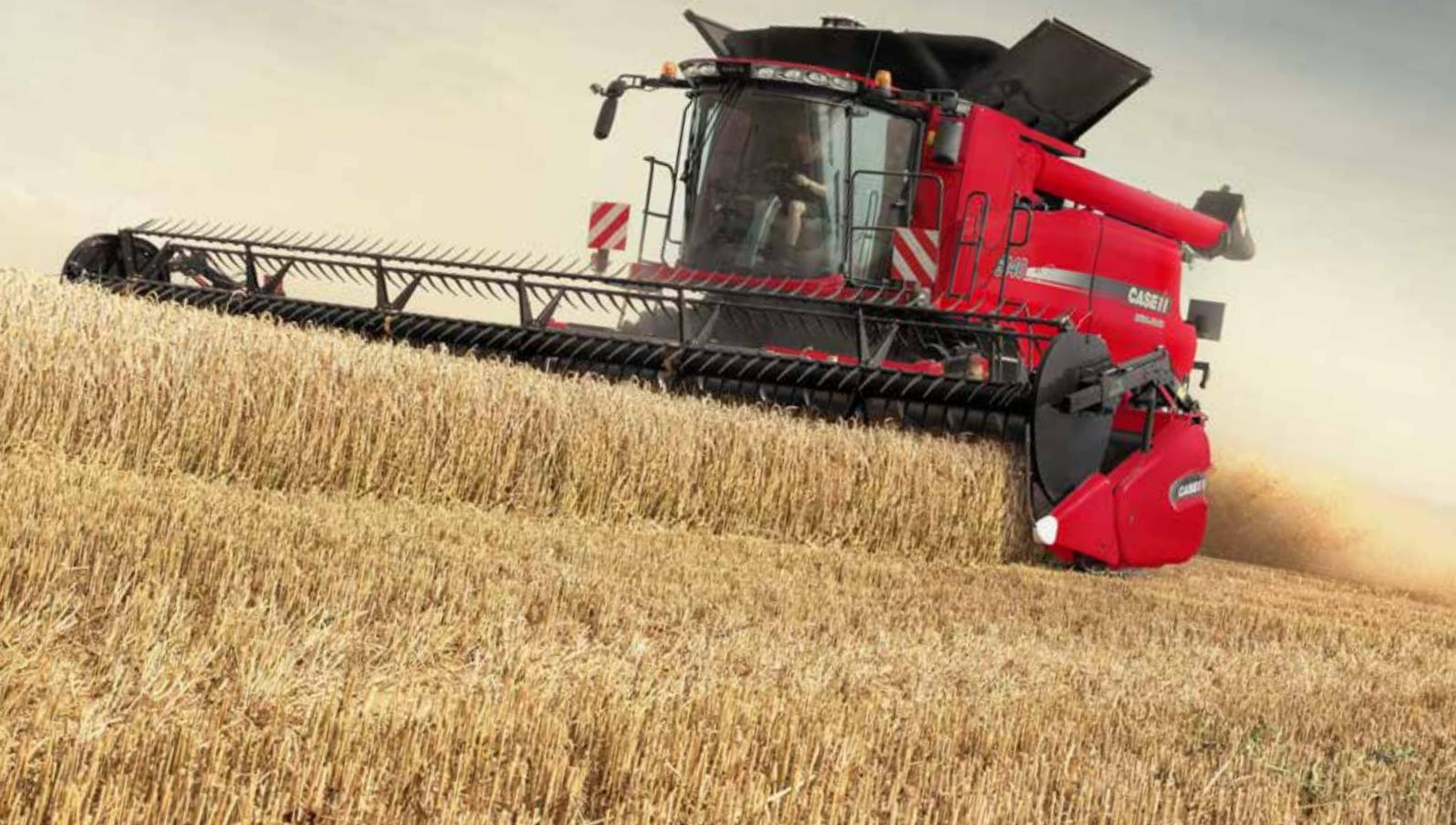
Die Axial-Flow®-Mähdrescher der Baureihe 140 sind mit dem fortschrittlichen Cross-Flow-Reinigungssystem ausgestattet, das beim Dreschen am Hang für maximale Produktivität sorgt; es gleicht automatisch Änderungen der Bodenneigung aus – von ebenem Boden bis 12° Hangneigung. Das Cross-Flow-Reinigungssystem stellt sicher, dass Sie immer mit optimaler Leistung dreschen – und es spart sogar Kraftstoff, denn es schaltet sich beim Abtanken im Stillstand und Wenden am Vorgewende automatisch aus.
