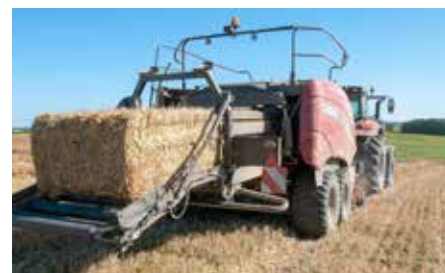
Le canal allongé de la LB424XL lui permet de débiter des balles de près de 370 kg, à près de 15 km/h.)
