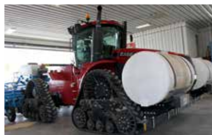
En Rowtrac version af Steiger Quadtrac 400 hjælper med at reducere jordkomprimering og beskadigelse af afgrøden i rækkerne.
