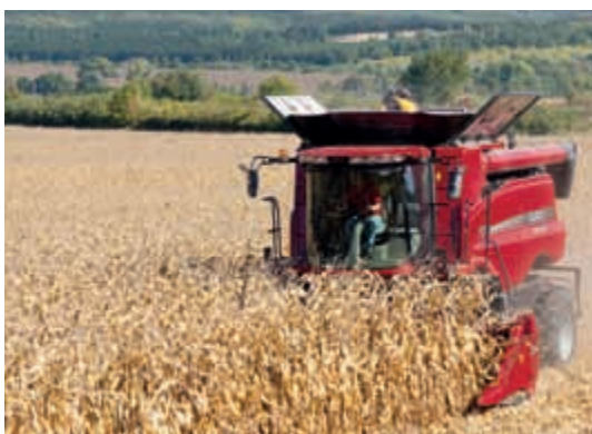
Mekanisk rækkestyring kombineret med GPS-signaler.
