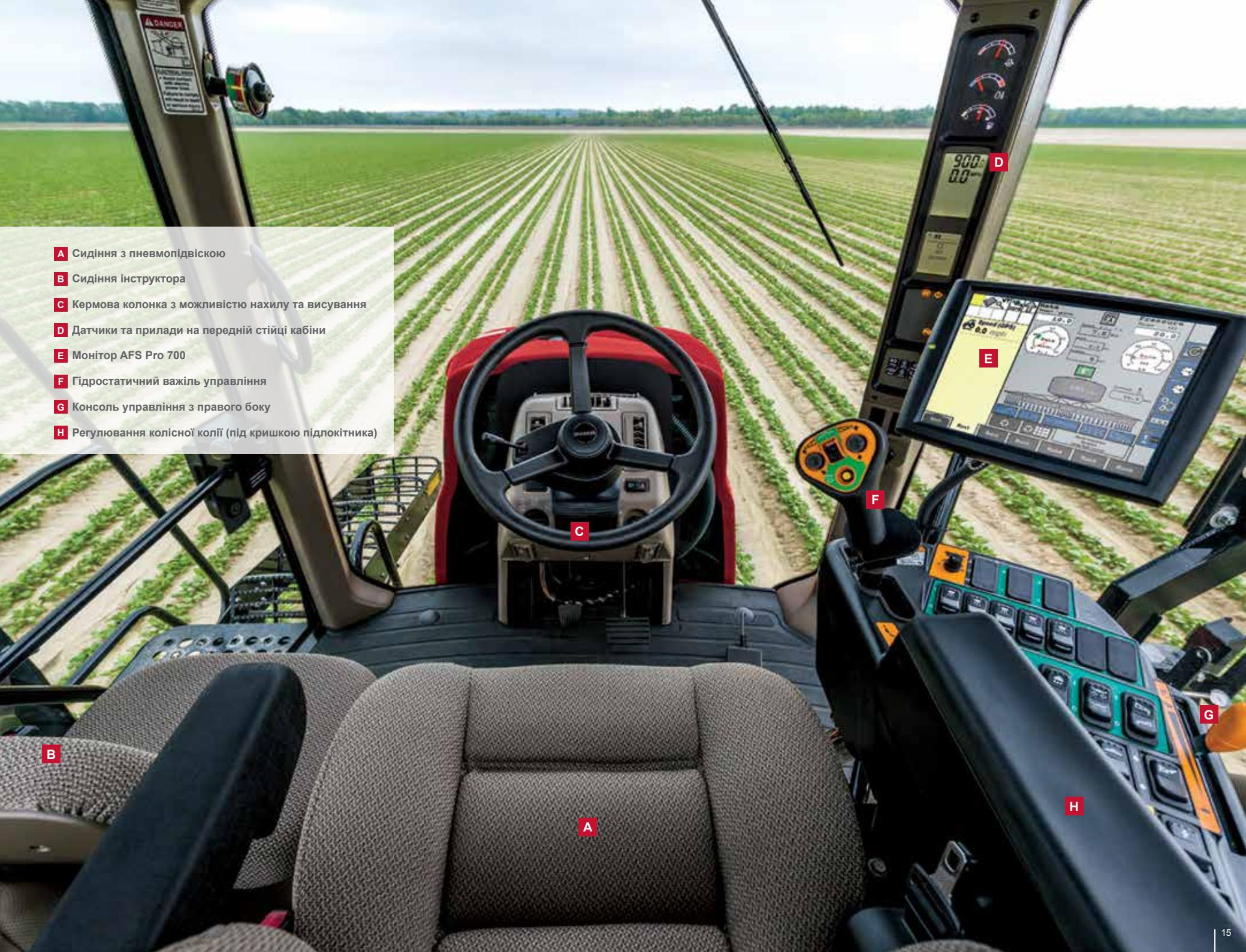
**A** Сидіння з пневмопідвіскою
