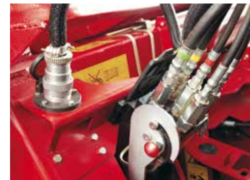
Montez la barre de coupe en un clin d'oeil avec le multi-coupleur qui relie tous les circuits hydrauliques.
