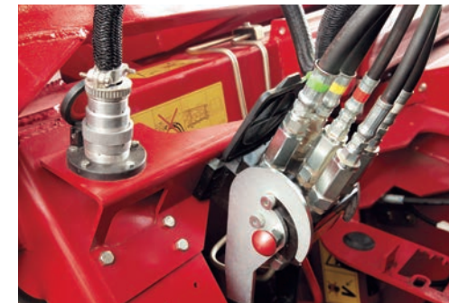
Навішування жатки займає всього декілька хвилин завдяки єдиному з'єднувальному механізму, який з'єднує всі гідравлічні комунікації
