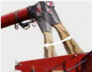
Die optionale verstellbare Auslass am Abtankrohr wird mit dem Multifunktionshebel bedient und richtet den Körnerstrom direkt auf den Zielbereich im Überladewagen, um Rieselverluste zu verhindern.
