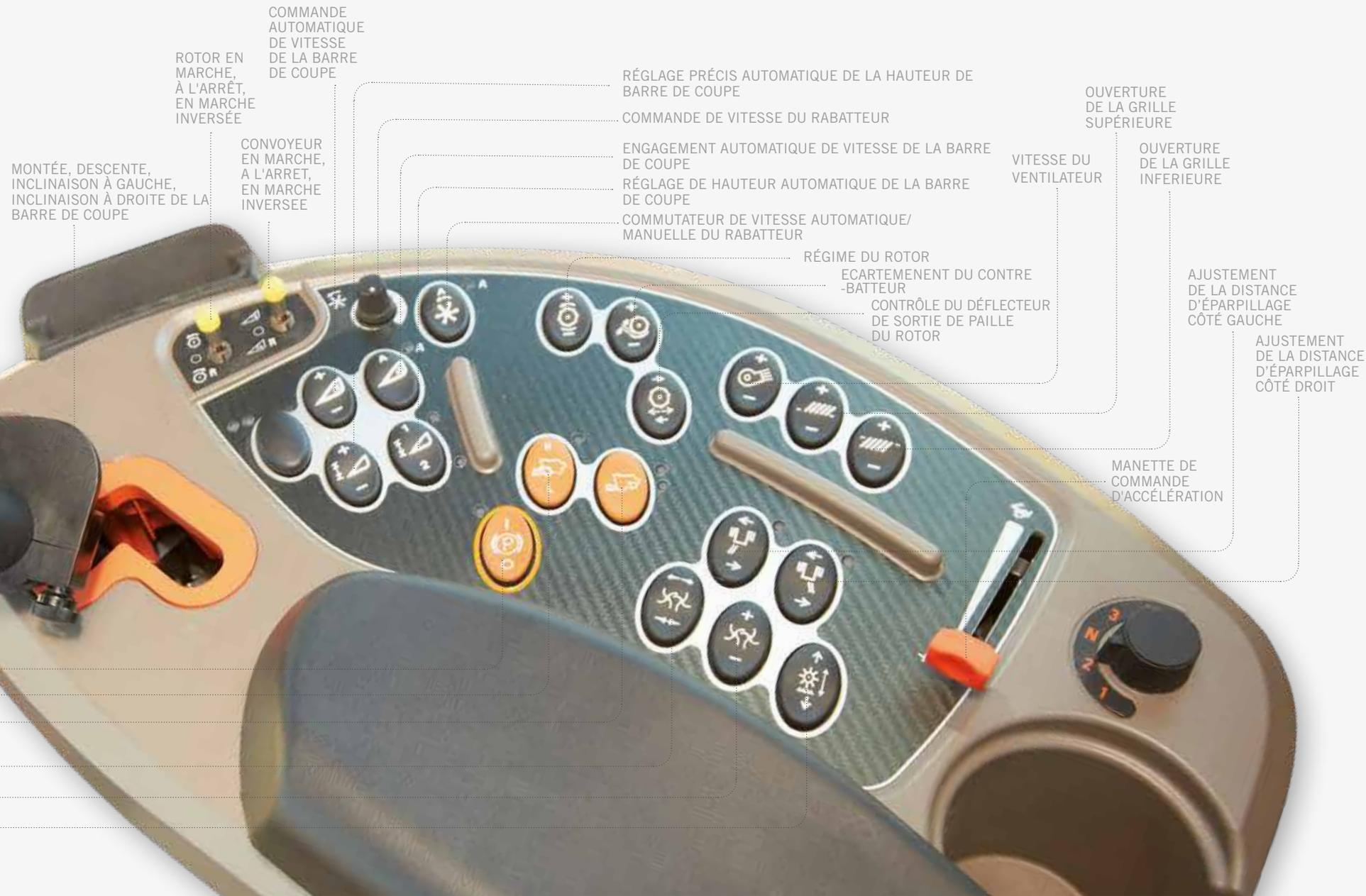
MONTÉE, DESCENTE, INCLINAISON À GAUCHE, INCLINAISON À DROITE DE LA BARRE DE COUPE
