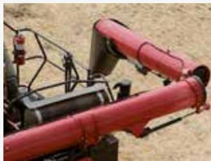
Les goulottes de vidange de 8,8 m et 10,4 m sont disponibles en version repliable pour un transport plus sécurisé sur route et pour faciliter les manœuvres de remisage sous hangars.
