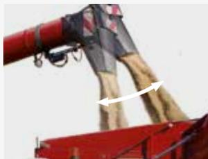
L'embout pivotant est actionné avec le levier multifonction. Il oriente le flux de grains dans la benne et permet de la remplir au maximum sans débordement.
