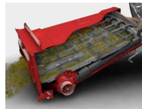
Il canale elevatore ad alta capacità, è in grado di "inghiottire" senza problemi i flussi più densi prodotti dalle testate più grandi del settore.
