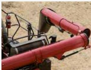
Il tubo di lancio della coclea di scarico da 8,8 m e da 10,4 m è disponibile anche in versione richiudibile per agevolare i trasferimenti su strada o le manovre nei capannoni per il rimessaggio.
