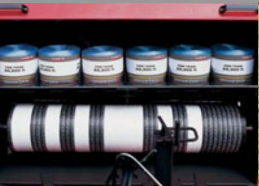
**RB 344 à dispositif d'enrubannage intégré -**
