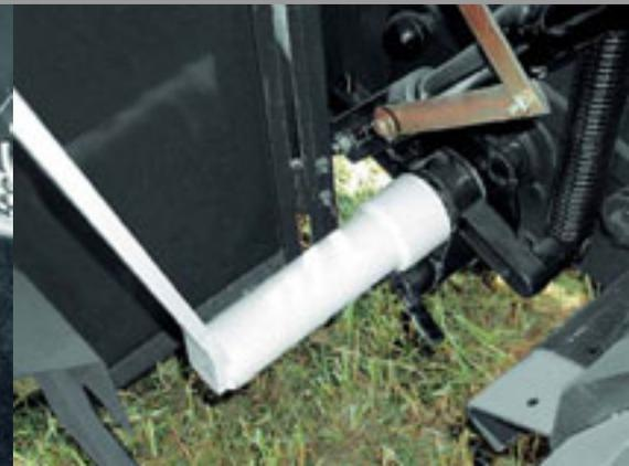
*Le rouleau inférieur robuste assure une rotation délicate et ferme de la balle.*
