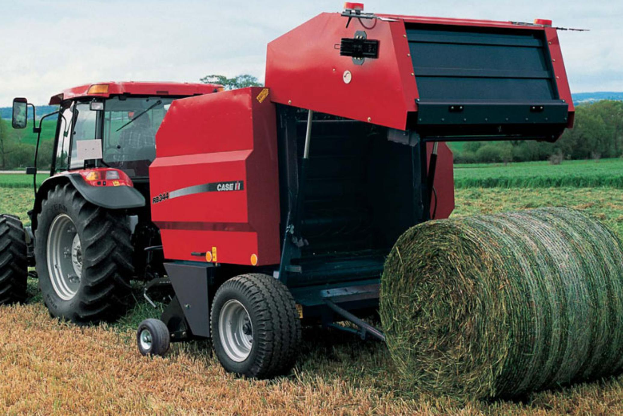
**Une formation des balles parfaite par un système chaînes et barrettes** sous tension automatique par ressort permet de produire des balles d'un diamètre d'1,25 m, dont la qualité et la densité sont exceptionnelles.
