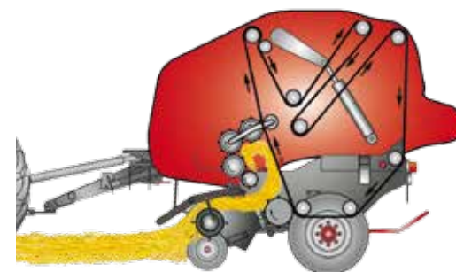
Połączone działanie pasów i rolek formujących gwarantuje optymalny kształt i stopień zgniotu bel.
