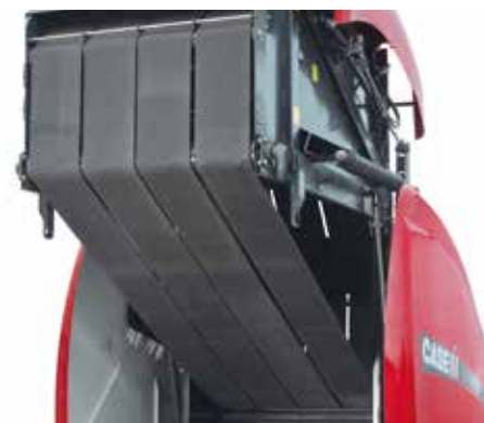
Cztery pasy bezszwowe zapewniają doskonałą przyczepność.
