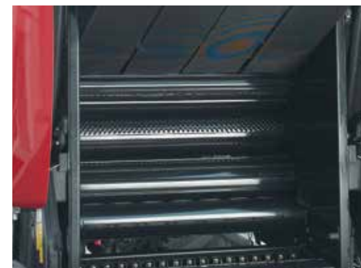
Rolki stalowe z wgłębieniami ułatwiającymi obracanie bel.
