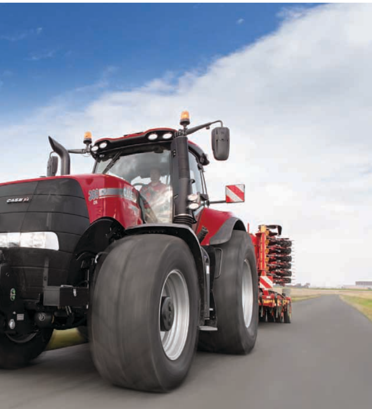
CVX transmission – trinløs kørsel mellem 0-40 km/t.
