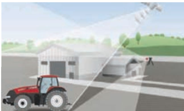
xFill dækker RTK-signaludfald i op til 20 minutter.
