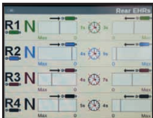
Kontrol af fjernventilerne med AFS 700 Pro skærm.
