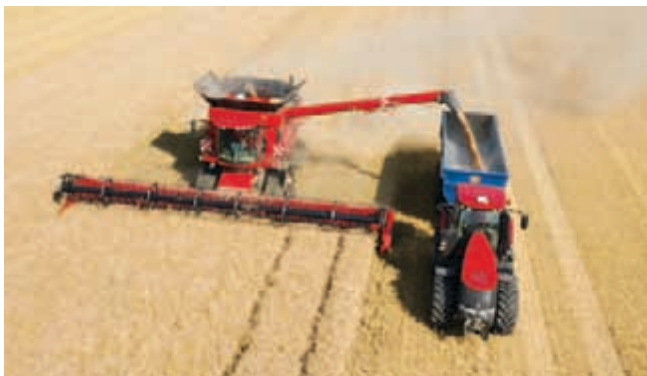
AFS AccuGuide: GPS og GLONASS baseret styring for ultimativ præcision, uafhængig af afgrødeforholdene. Præcisionsniveauer ned til 2,5 cm.
