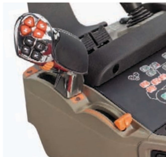
Enestående effektivitet. Vælg din hastighed mellem 0 til 40 km/t. med blot et håndtag eller en pedal.
