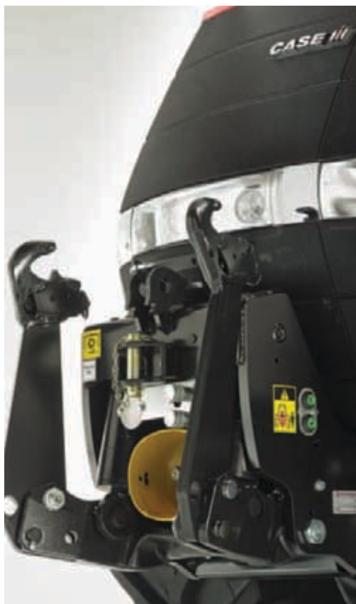
Perfekt integreret frontlift med en løftekapacitet på 5.000 kg.
