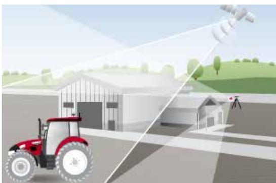
**Il sistema xFill** assicura fino a 20 minuti di connettività di bridging per il mantenimento, in caso di perdita, del segnale RTK.
