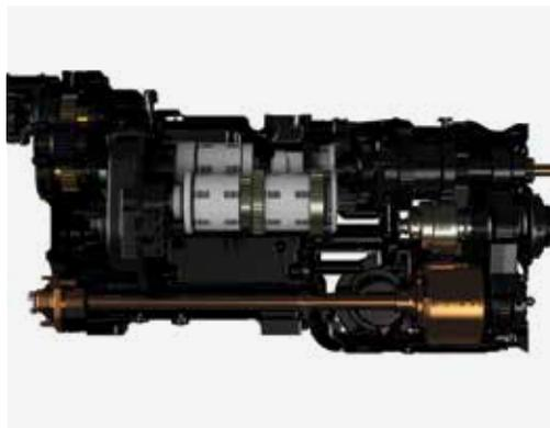
Trasmissione Full Powershift 23x6 con superriduttore.
