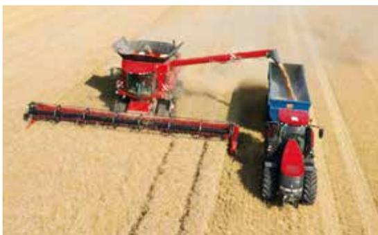
**Sistema AFS AccuGuide:** sistema di guida con GPS e GLONASS per la massima precisione indipendentemente dalle condizioni della coltura o del prodotto. Livelli di precisione fino a 2,5 cm.
