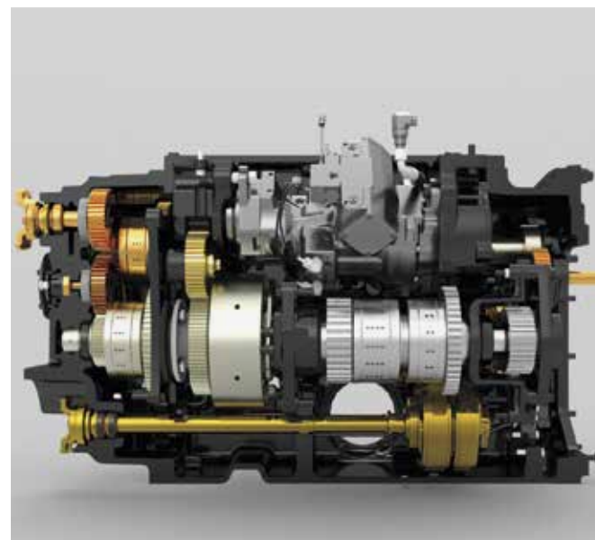
Przekładnia CVX – napęd bezstopniowy w zakresie prędkości od 0 do 50 km/h.
