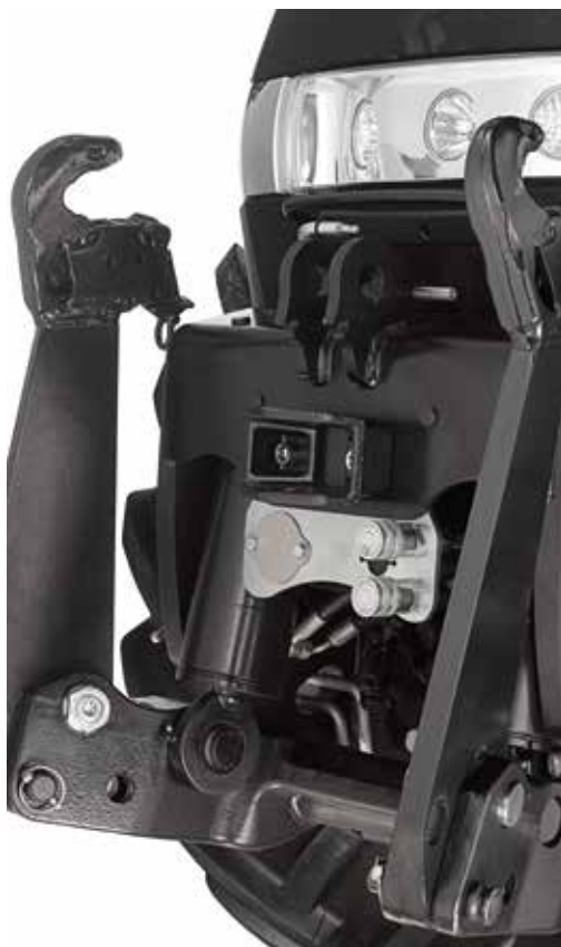
Doskonale zintegrowany przedni układ zawieszenia narzędzia o udźwigu 5000 kg.
