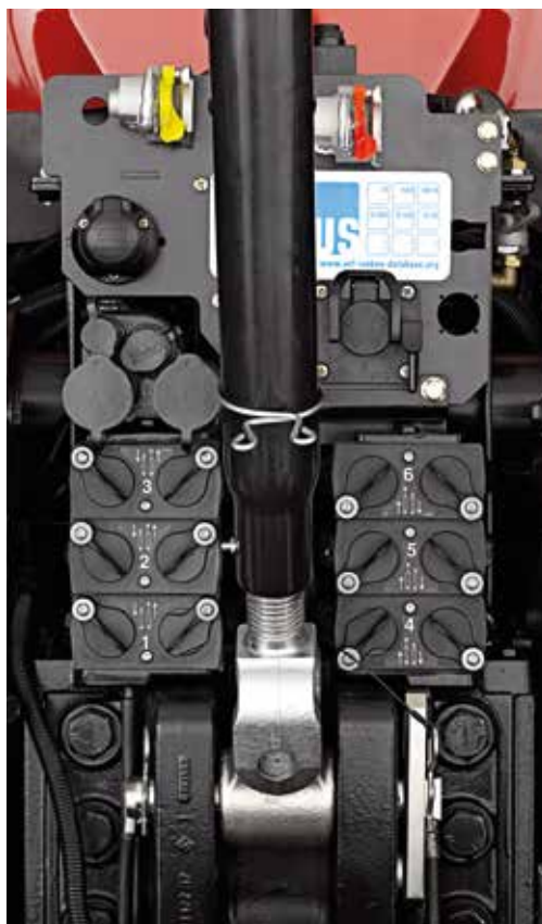
Brak ograniczeń podczas pracy dzięki 6 tylnym elektrohydraulicznym zaworom zdalnym.
