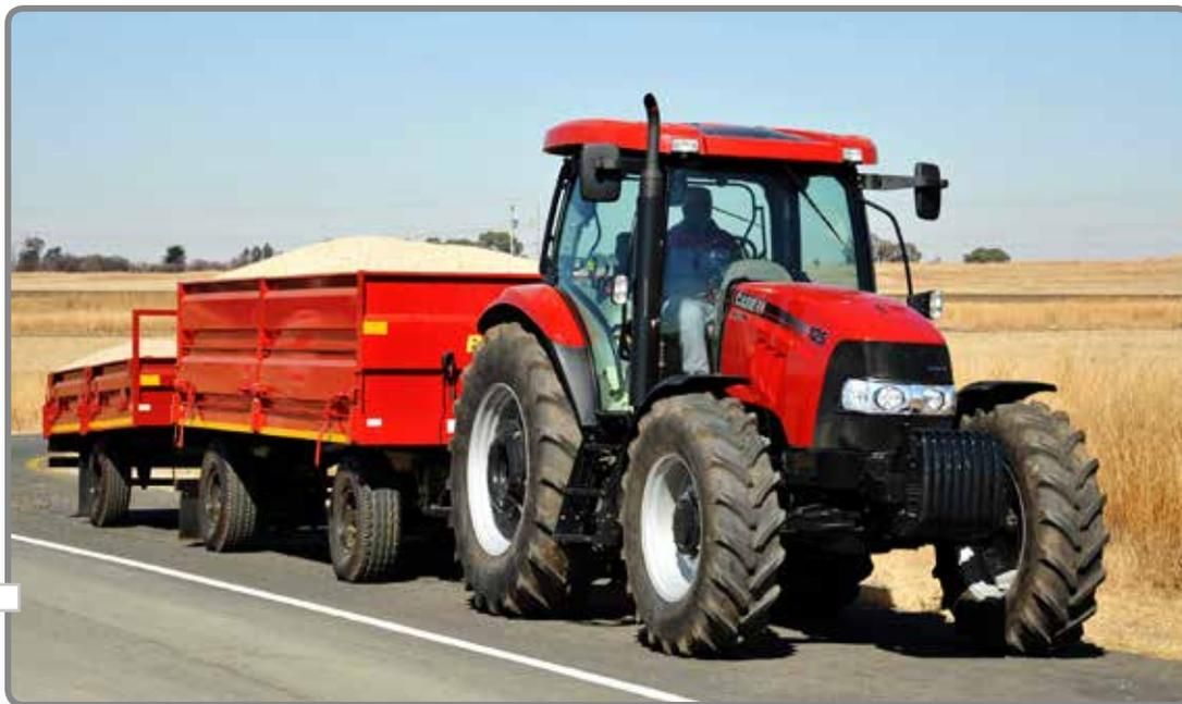
Choisissez parmi les options de transmission 12 x 12, 24 x 24 ou 16 x 16 de série sur les modèles Maxxum Value. Sur les modèles Maxxum 140 Limited, la transmission 24 x 24 est disponible de série, tandis que la transmission Semi-Powershift Econo 16 x 16 et 17 x 16 avec Autoshift est offerte en option sur tous les modèles Limited. Le 17e rapport ralentit le régime moteur aux vitesses élevées, d'où une économie de carburant accrue et un fonctionnement plus silencieux lors du transport.
