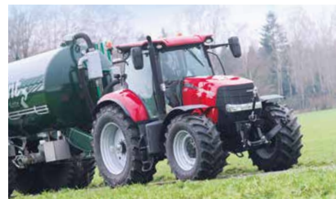
Active Stop håller traktorn stillastående utan att använda bromsarna
