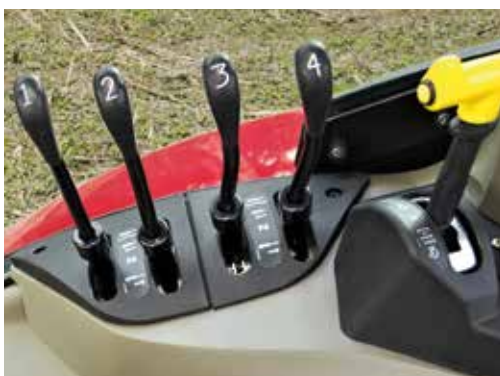
Upp till 4 mekaniska hydraulventiler finns att få.
