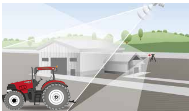
xFill täcker upp för luckor i RTK-signalen i upp till 20 minuter.
