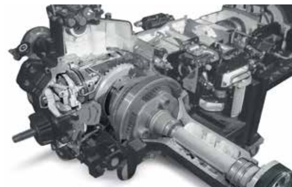
6-hastighets Semi-Powershift-och Full Powershift transmission maximerar effektiviteten och ökar produktiviteten på åkern och vägen.
