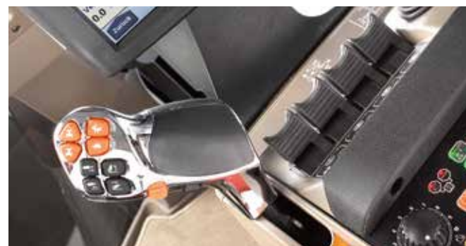
Multicontroller™ tillåter växling utan koppling.
