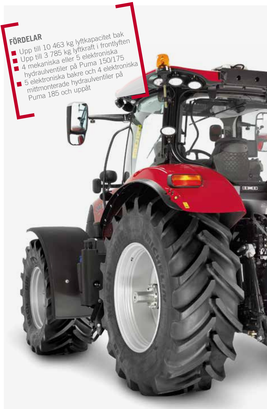
Inga manövreringsbegränsningar med 5 elektronisk-hydrauliska bakre hydraulventiler.
