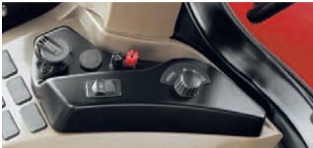
▲ **Sélection facile des vitesses de PdF** depuis l'intérieur de la cabine, à l'aide du sélecteur électrique de vitesses (ESS) en option.
