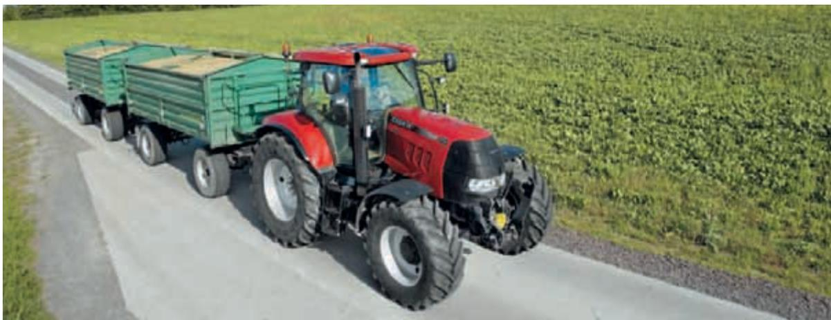
► **La transmission intégrale** permet un passage de vitesses en souplesse de zéro à 40 ou 50 km/h. Transmission CVT en option pour une consommation de carburant améliorée et un plus grand confort du conducteur.
