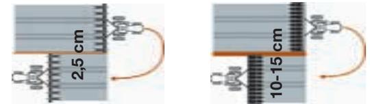
▲ En vous permettant de choisir le degré de précision le mieux adapté à vos besoins; choisissez votre **Case IH AFS AccuGuide®** avec 10 à 15 cm (avec correction OmniStar) ou 2,5 cm (avec correction RTK).
