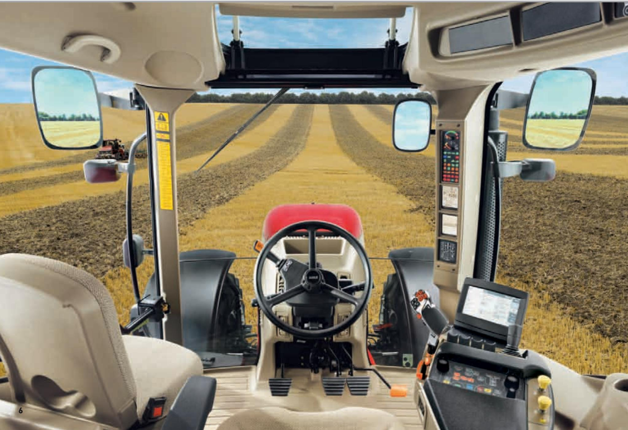
► **Un groupe d'instruments de bord avec un écran de performances en option** surveille les fonctions et les données importantes pour une surveillance pratique d'un seul coup d'œil.
