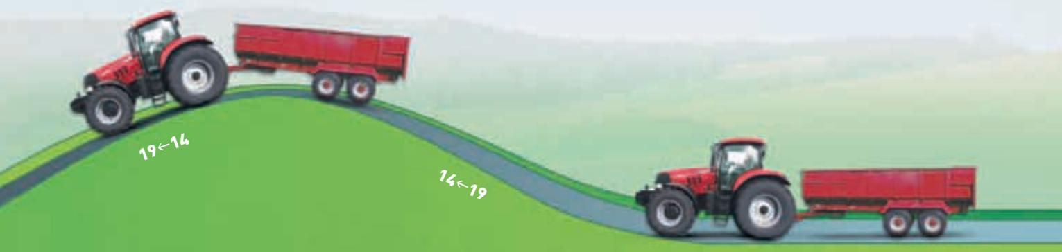
◀ Les modes AutoField et AutoRoad optimisent la transmission et permettent le passage automatique des vitesses selon la charge, afin d'augmenter la productivité et les économies de carburant. Les passages de vitesses se font en souplesse car ils sont basés sur la charge. Pour de petites charges, les changements de vitesse sont lents, pour de grandes charges, ils sont rapides.
