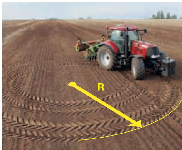
◀ Un rayon de braquage impressionnant. Grâce aux dimensions compactes du moteur, les tracteurs Puma ont un rayon de braquage extrêmement court. Les ailes dynamiques donnent à ces tracteurs 30% de plus d'angle de direction, avec une maniabilité magnifique.
