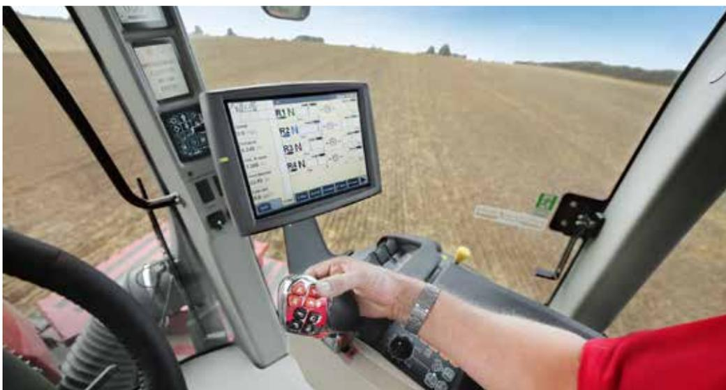
Le joystick, de série sur les tracteurs équipés de 8 distributeurs, permet d'actionner ces derniers très facilement.
