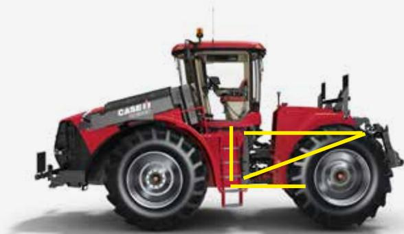
Le châssis du Steiger, breveté, utilise une articulation 3 points, qui assure une répartition homogène des charges pour une meilleure longévité, résistance et stabilité
