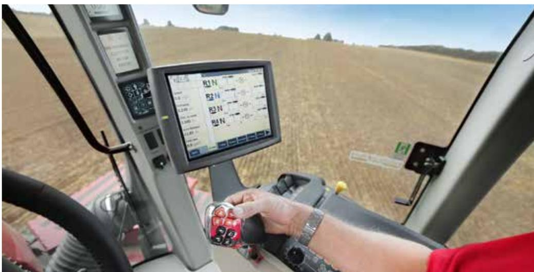
Il comando a joystick, fornito di serie quando si ordina la configurazione con 8 distributori ausiliari, facilita l'azionamento di tutte le funzioni dei distributori.
