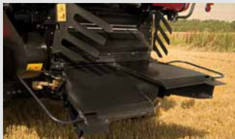
System rozdrabniania X-tra Chopping z niezależnymi płytami rozrzućnika
