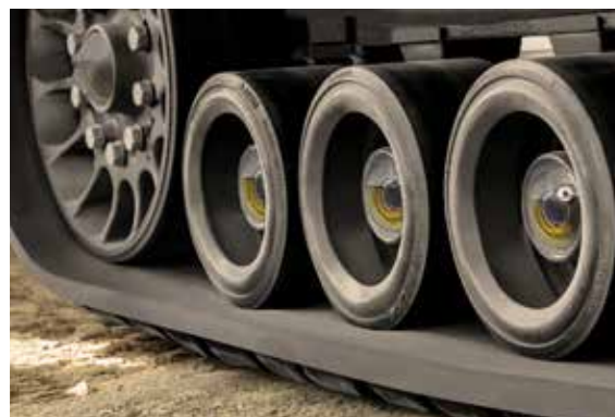
Wzierniki do kontroli poziomu oleju w piasku ułatwiają codzienną konserwację.
