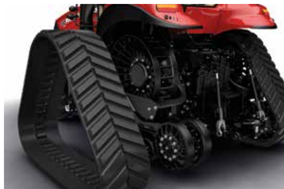
Bezpośredni układ przeniesienia napędu eliminuje poślizg pomiędzy kołem napędowym a gumową gąsienicą w każdych warunkach.
