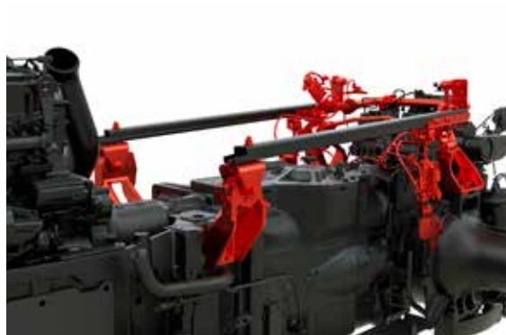
Półaktywna hydrauliczna amortyzacja kabiny skutecznie tłumi wibracje i podskoki na nierównościach.
