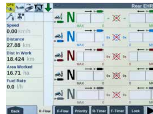
Natężenie przepływu i ustawienia regulatorów czasowych widoczne w jednym miejscu na monitorze AFS Pro 700™.
