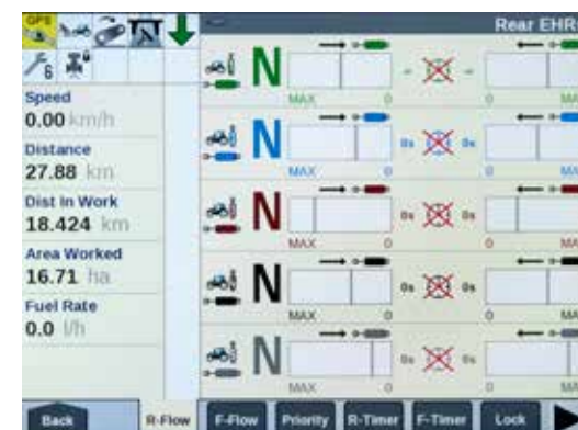
Enkel översikt av flödes hastighet och timer-inställningar på AFS Pro 700i-skärmen.
