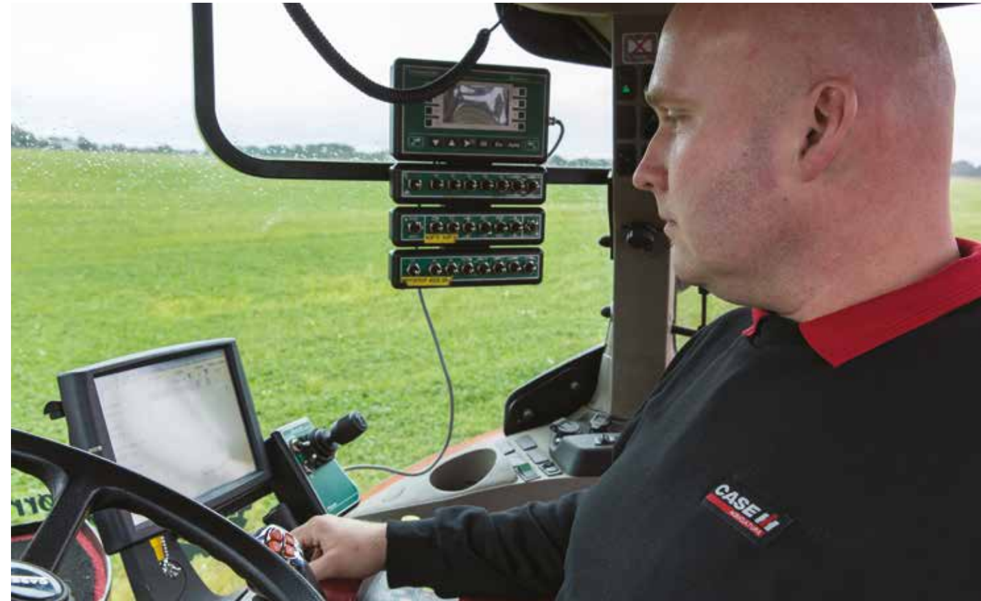
Søren H. Nielsen i kabinen på den ene Puma med RTK-anlæg. AFS 700 skærmen er stor og betjenes med en fingerspids. Den er også nem at finde rundt i på en logisk måde.
