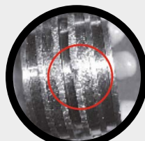
ПОШКОДЖЕННЯ ПОРШНЯ НАСОСА
