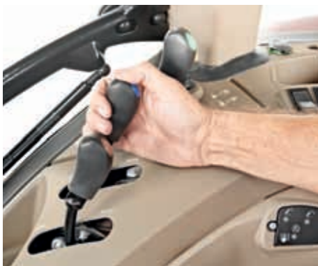
Der er op til tre mekaniske, bagerste fjernventiler til rådighed for Farmall C Serien.
