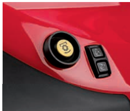
Udvendig betjening for hurtig og let montering af redskaber.
