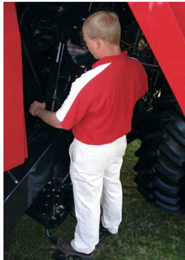
El ajuste de la cadena del elevador de granos limpios desde el suelo vuelve la operación de tensado rápida y fácil. La cabeza del elevador y el sensor de carga del monitor de rendimiento se mueven en un cabezal pivotante para asegurar lecturas precisas de rendimiento, al mismo tiempo que reducen las necesidades de calibración.
