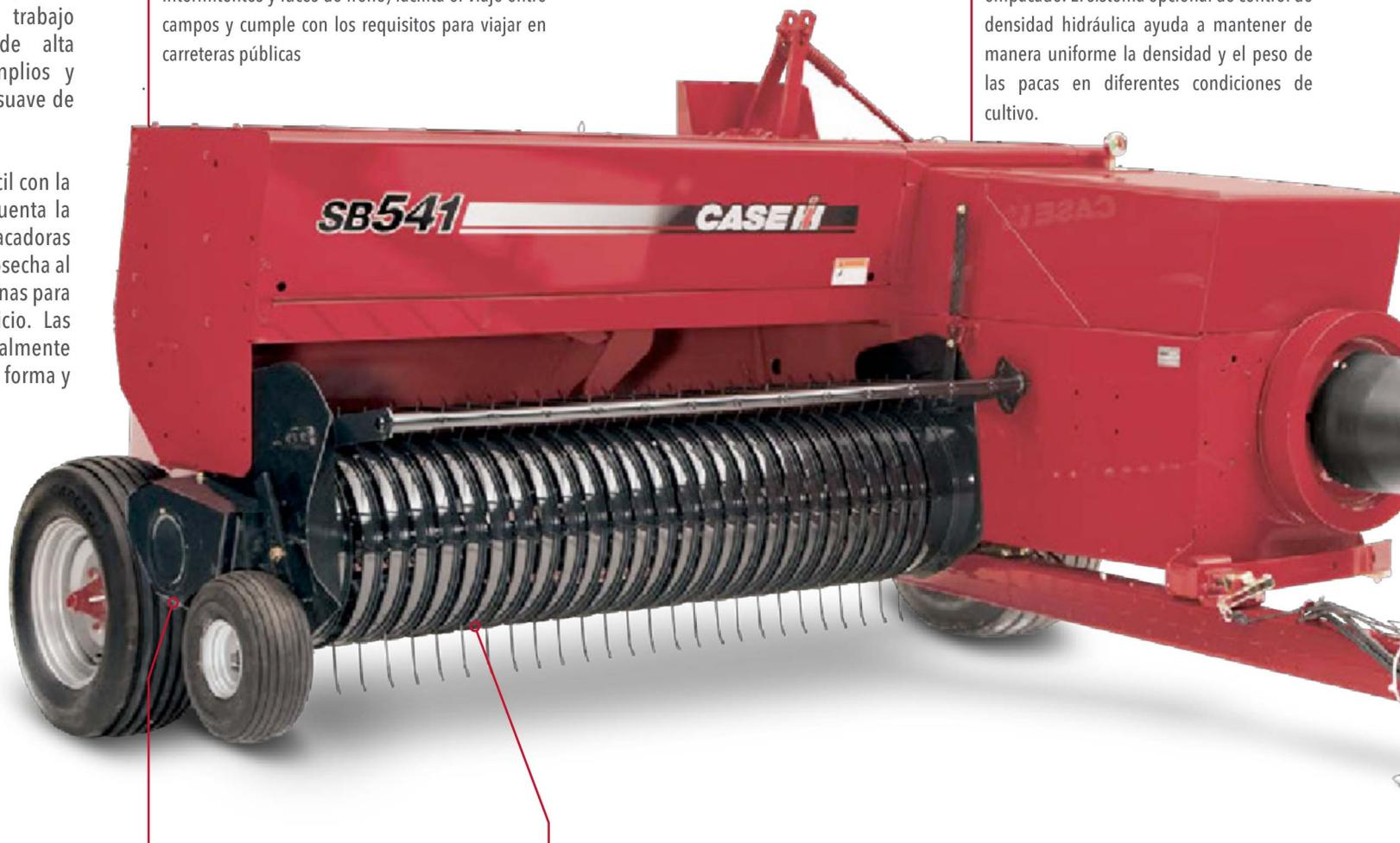
La protección de acceso a la cadena de transmisión del recogedor es de fácil acceso a los puntos de servicio.
