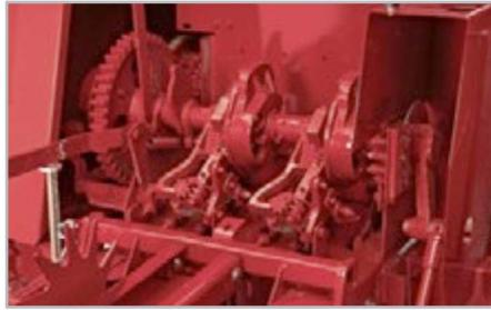
Los anudadores son impulsados por engranajes y diseñados para ser duraderos, con un atado consistente y de bajo mantenimiento.
