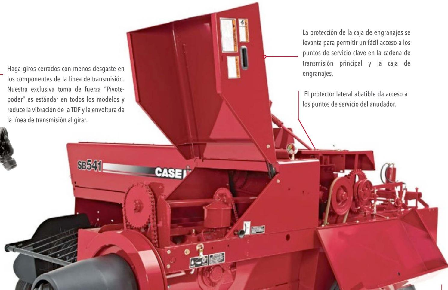
La protección de la caja de engranajes se levanta para permitir un fácil acceso a los puntos de servicio clave en la cadena de transmisión principal y la caja de engranajes.
