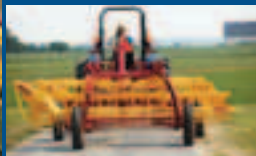
Le transporteur pour modèle 252 offre une largeur de transport de 2,75 m (8 pieds et 11 pouces)
