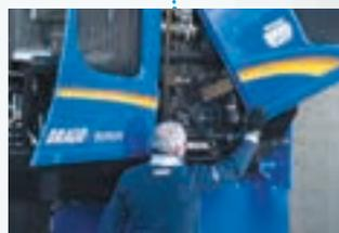
Le capot moteur constitué de deux éléments s'ouvre en grand pour permettre un accès total lors des travaux d'entretien : le capot avant bascule parfaitement afin d'accéder au moteur, la porte latérale s'ouvre avec un vérin pneumatique pour faciliter le nettoyage et l'entretien du système hydraulique et des refroidisseurs.
