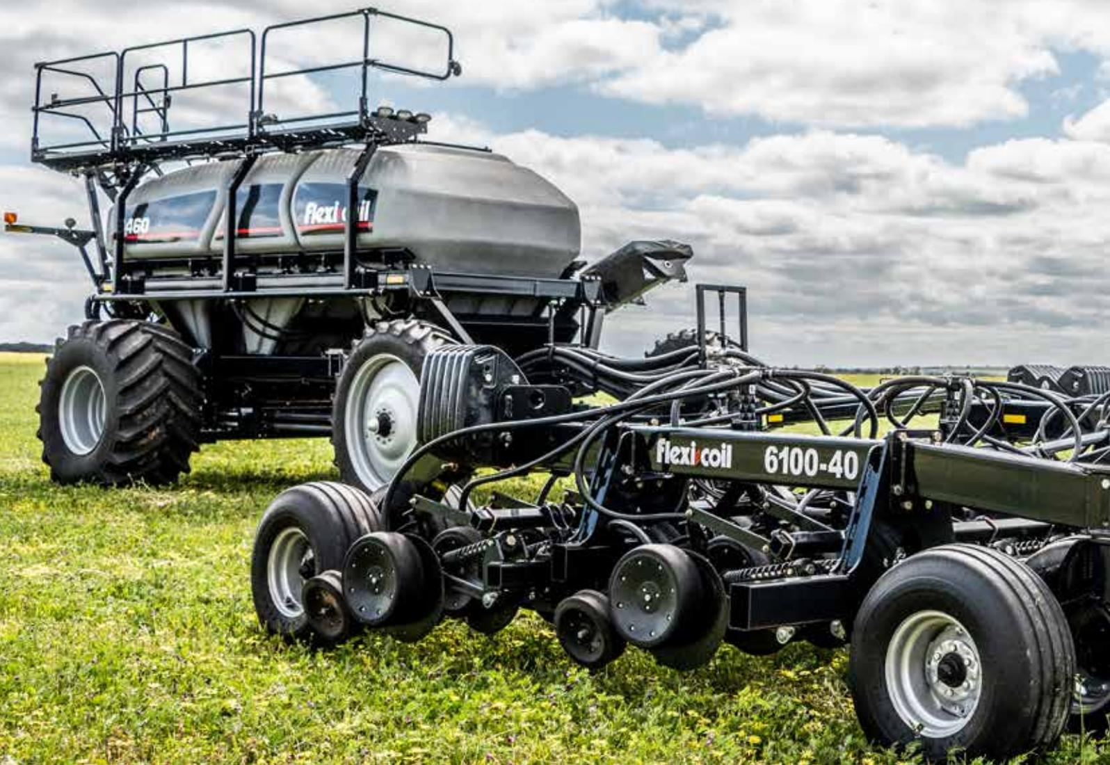
Уникальная, запатентована пружина прижима удерживает нож и диск в почве, а вместе с гидравлическими цилиндрами прижима (регулируемыми из кабины) обеспечивает постоянный контакт секции с почвой.
