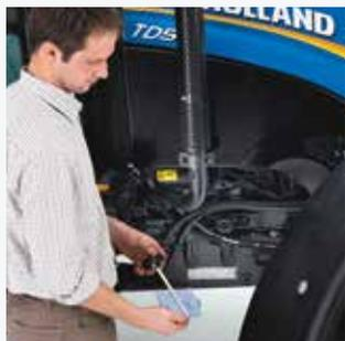
Для проверки уровня моторного масла и гидравлической жидкости не требуется открывать капот, что упрощает проверку и обслуживание.
