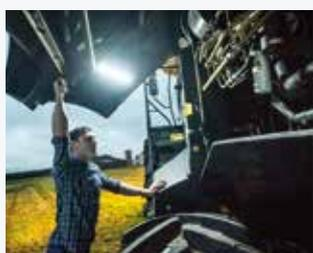
Новые светодиодные осветительные приборы под крышкой картера двигателя облегчают проведение работ по техническому обслуживанию в условиях низкой освещенности.
