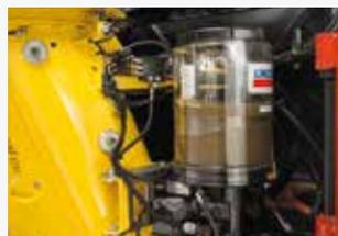
Предусмотрена централизованная автоматическая система смазки.
