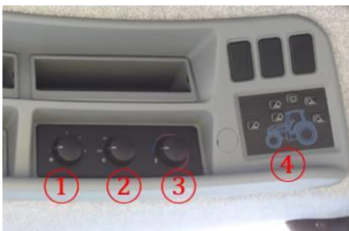
1. 空调风量选择旋钮 2. 空调制冷开关 3. 温度调节旋钮 4. 车辆灯光开关
