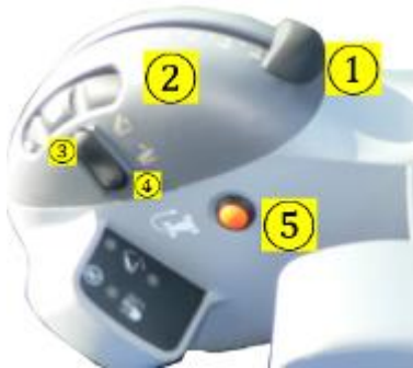
1. 位置调节控制 2. 力控调节制3. 三点悬挂快速上升 4. 三点悬挂快速下降
