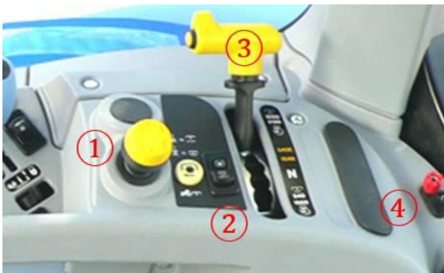
1. PTO结合断开按钮 2. PTO制动器释放开关 3. PTO速度选择手柄 4. 12V电源接口
