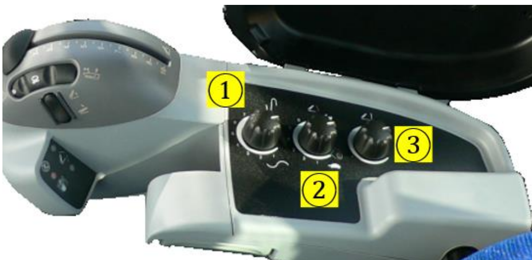
1. 牵引灵敏度旋钮 2. 下降速率控制旋钮及液压锁 3. 三点悬挂高度限定旋钮
