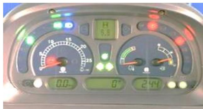
**注：**在钥匙开关打开时，电器开始系统自检，此时所有的报警灯会亮起一段时间。启动拖拉机前，打开钥匙开关后请等待自检结束后再启动发动机，避免拖拉机相关模块数据丢失。
