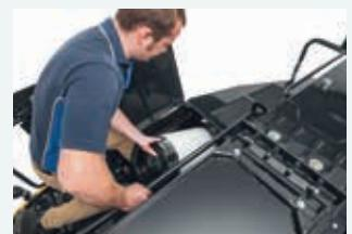
Bekvem adgang til motoren luftfilter.
