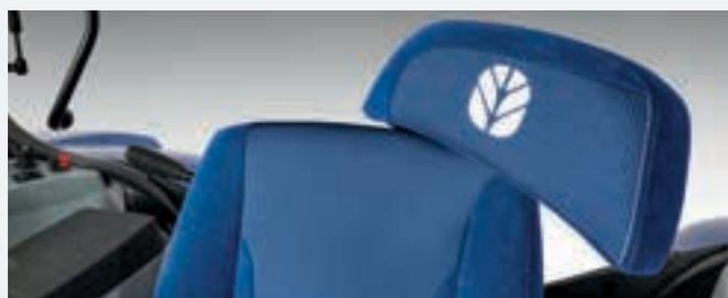
Sowohl die Dynamic Comfort™- als auch die Comfort-Sitze verfügen über eine neue ausziehbare Rückenlehne, die der oberen Rückenpartie zusätzlichen Halt gibt und den Komfort erheblich verbessert, wenn der Sitz gedreht wird, um die Heckanbaugeräte zu kontrollieren.
