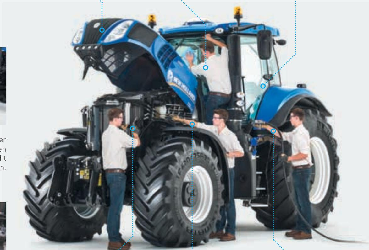
Die Kühleinheit ist zur einfacheren und schnelleren Reinigung ausschwenkbar.
