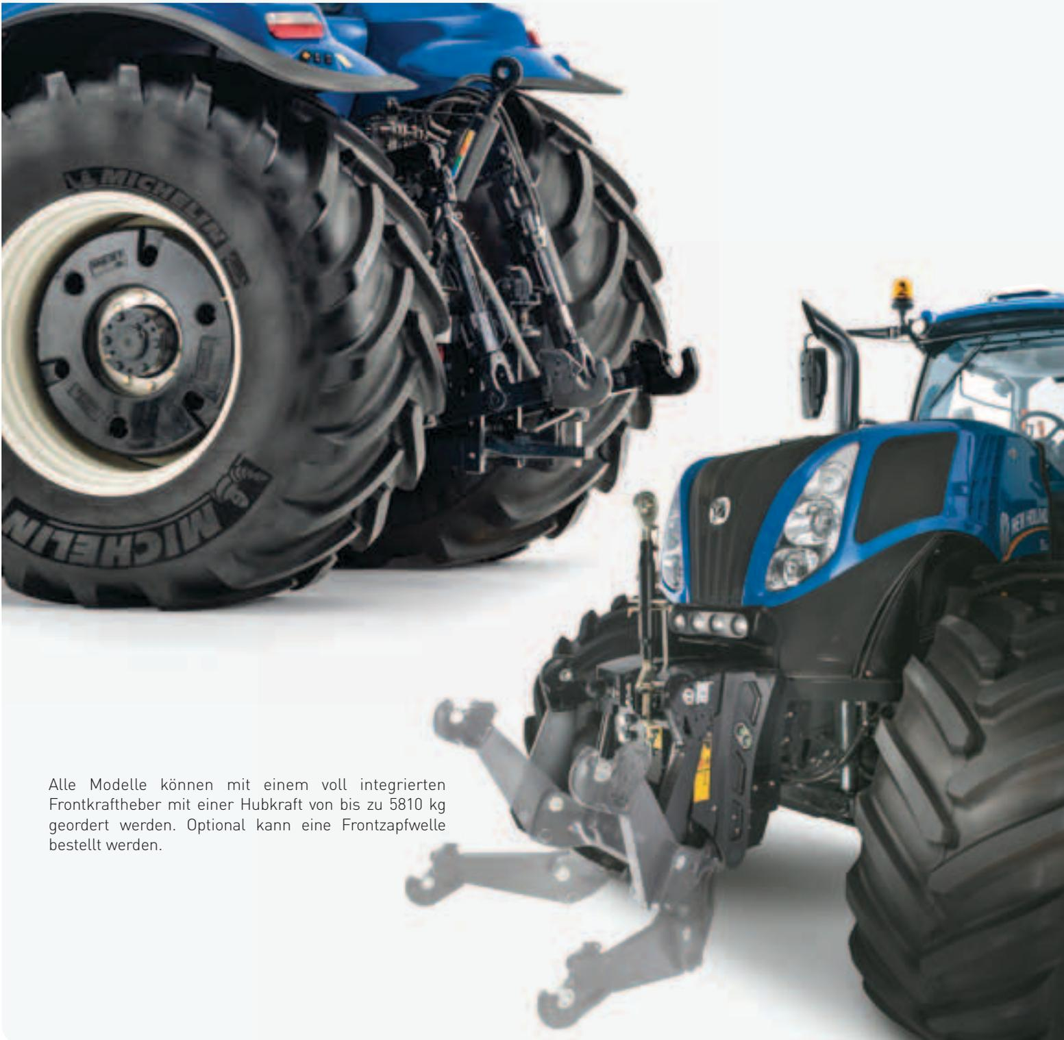
Alle Modelle können mit einem voll integrierten Frontkraftheber mit einer Hubkraft von bis zu 5810 kg geordert werden. Optional kann eine Frontzapfwelle bestellt werden.
