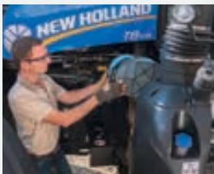
Der Luftfilter kann ohne Aufstellen der Motorhaube kontrolliert, gereinigt und ausgewechselt werden.
