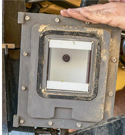
Im Körnerelevator sitzen Feuchte- und Ertragsmessung sowie die Kamera für die Kornqualität. Die muss man im feuchten Raps schon mal reinigen, auch um die automatische Maschineneinstellung nutzen zu können.
