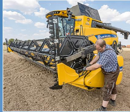
Das 10,70 m breite VariFeed-Schneidwerk macht super Arbeit, nur der An- und Abbau könnten einfacher sein. Neu sind die Rapstrenner mit Ölmotor unten.
