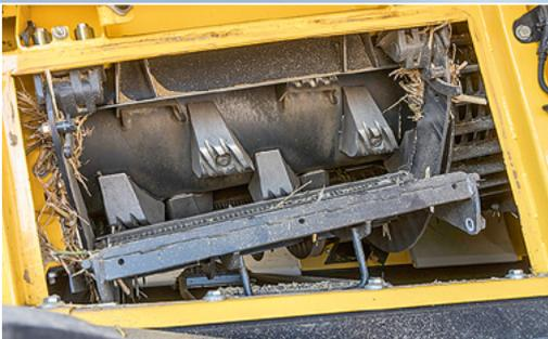
Die „TwinPitch Plus“-Rotoren haben weniger Kerndurchmesser und höhere Reibleisten.
