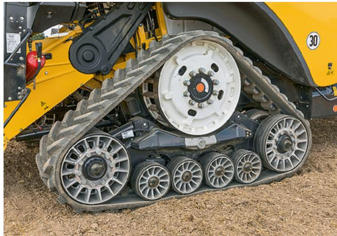
Die 61 cm breiten Rau-pen sorgen für 3,49 m Außenbreite und stehen schön lang auf. Auf der Straße sind damit maximal 30 km/h möglich, mit der optionalen hydraulischen Federung gehen auch 40 km/h.
