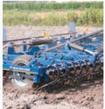
Die SBM V Serie ist mit 4 verschiedenen Zinken und Zinkenabständen verfügbar, für eine optimale Einsatz unter verschiedenen Bedingungen.
