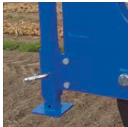
Die serienmäßigen Stützen ermöglichen den einfachen und sicheren An- und Abbau des SU Paragrubber.
