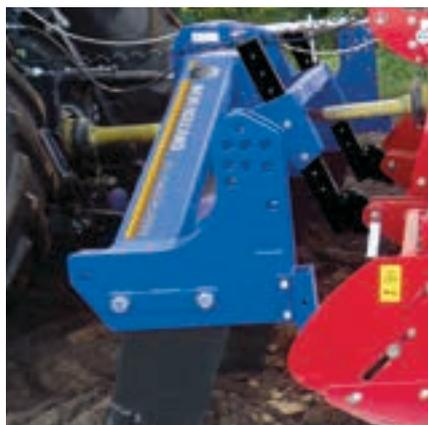
Kompaktrahmen und serienmäßiger Dreipunktbau zum Befestigen von heckmontierten PTO-Anbaugeräten.
