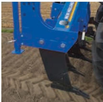
Schwerlastrahmen mit 6 speziell angewinkelten Zinken mit schnell und einfach auswechselbaren Punkten.
