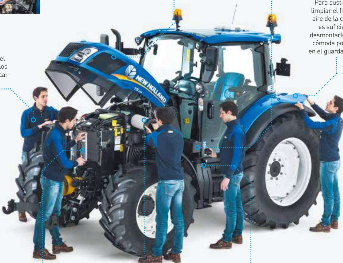
El sistema de refrigeración se abre para permitir una limpieza fácil y eficiente.
