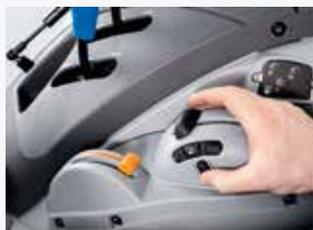
Los mandos del avanzado elevador electrónico (EDC) están dispuestos de forma idónea para regular con precisión la velocidad de bajada, el limitador de altura, la sensibilidad y el deslizamiento, y lograr así un cultivo uniforme y la máxima tracción en todo momento.
