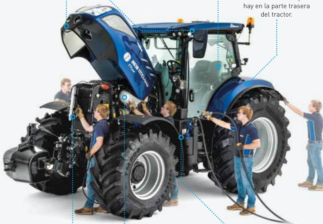
El sistema de refrigeración se abre para facilitar y agilizar la limpieza.
